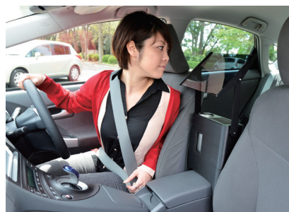
実験車両では、運転席の横後方に、プロジェクターとハーフミラーを設置している。ハーフミラーの位置と角度調節で、美しく見えるかどうか左右される。
