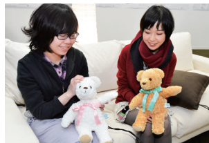
Robot PHONE (ロボットフォン)。声だけでなく、ロボット(クマのぬいぐるみ)を介して身振りが伝えられる電話。一人がクマの手を持ち上げると、通話相手の持っているクマの手も同じ動作をする。
