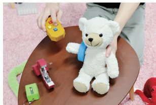
PINOKY (ピノキー)。ぬいぐるみなどに取り付けるだけで、手足、尻尾を動かすことができるリング型のデバイス。アクセサリ感覚で、ロボット化ができる。
