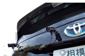
車両の後部に取り付けられたカメラ。2～3機のカメラで撮影し、PCを使って統合していく。
