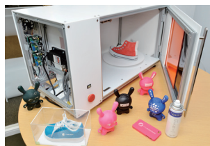
SHADER PRINTER (シェーダープリンター)。特殊なインク(サーモクロミックインク)とレーザーを利用し、投影したCGを印刷する技術。複雑な自由曲面にも印刷でき、自由に書き換えられる。
