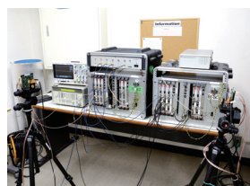
ミリ波チャネルサウンダ(実験装置)。
