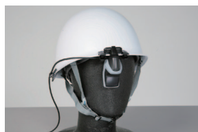
図1 ヘッドマウントディスプレイは、現在ほとんど唯一のウェアラブル機器である。しかし、出力はできても入力ができないため、コミュニケーションツールとしては十分ではない。写真は、嵯島津製作所のDATA GLASS3/A。クリップでヘルメットに直付けしたり、ヘッドバンドで装着する。
