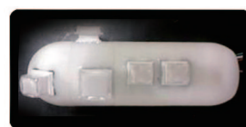
図7 簡易かな入力装置。上の入力装置を握り、子音テンキーにポインタを合わせてボタンを押す。五つのスイッチと空中マウス機能を内蔵。母音が五つより多い言語には使えないのが難点ではある。
