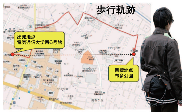
図4 めがねナビの実証実験。直線距離で約700メートルの目標を先にインプットし、本人には知らせていないが、無事に到着することができた。
