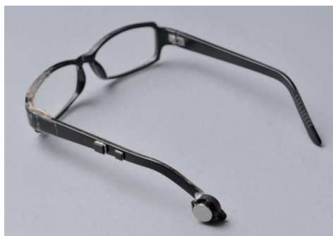
図3 めがねナビ実用機の実現イメージ。レンズフレームにLED、側面に電池、方位センサー、マイコン、受信機を埋め込んでいる。
