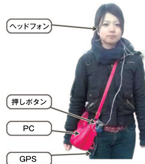
図4 めがねナビの実証実験。直線距離で約700メートルの目標を先にインプットし、本人には知らせていないが、無事に到着することができた。
