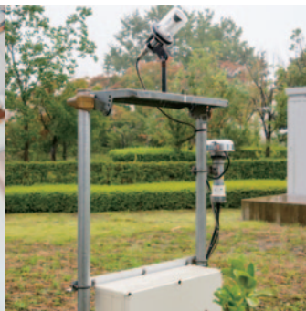
家の内外のあらゆるところにセンサーが取り付けられ、人の動き、生活活動によって、室内の温度や湿度がどう変化するかをモニターしている。
