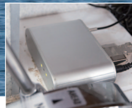
漁船に搭載された各種の機器のデータを収集するためのコンピュータ、「マイクロキューブ」が各漁船に装備されている。
