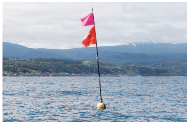
水深別に温度を計測するユビキタスブイも和田教授が開発した。水温は漁獲量に大きな影響があるが、漁業者の経験からは分からなかったデータである。
