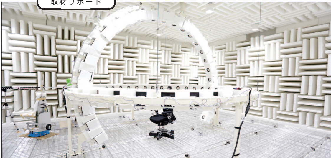
音の空間知覚に関する実験に用いるスピーカアレイ。
