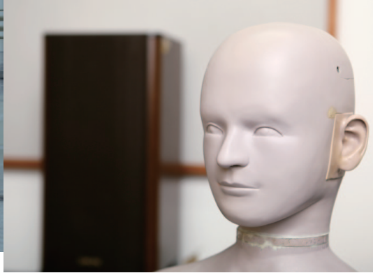
計測用のダミーヘッド。ある人物の頭部を再現したものだ。
