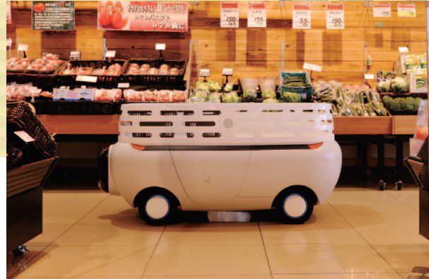
店舗など屋内で人やモノを運ぶために開発された「ロージー」。役割が異なる3台でシステムを作り上げているところがミソだ。
