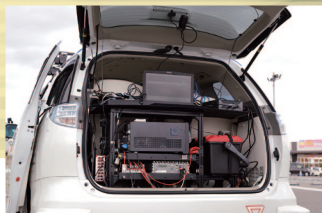
実験車両の後部にはコンピューターをはじめ多くの器材が積まれている。将来はコンパクトにまとめられてAIパイロットの中に入る予定。
