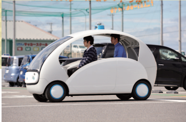
駐車場内を行き来する「マイリー」。ゴルフカートを改造して製作された。
