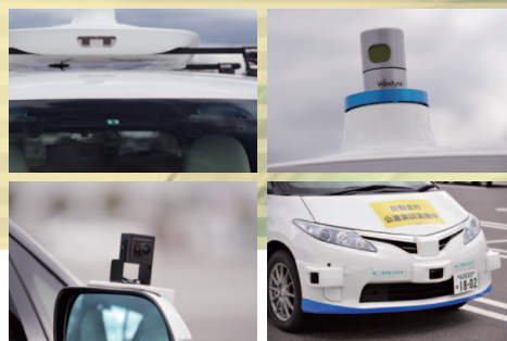
公道を走行するエスティマには数多くのセンサーが取り付けられている。フロントガラスには信号の色を読み取るカメラも(左上)。
