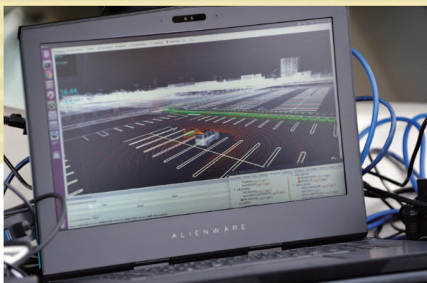
自動運転車を制御するソフトウェア「Autoware」の画面。レーダーを使って得たデータでクルマの位置を正確に特定する。
