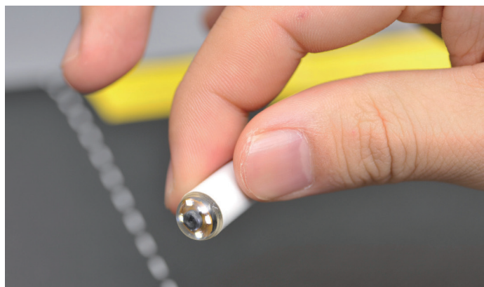
カプセル型内視鏡の実現例
