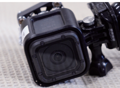
カメラが時々動作しなくなる原因を調べるために、蒸し器の中に入れて動作確認をした
