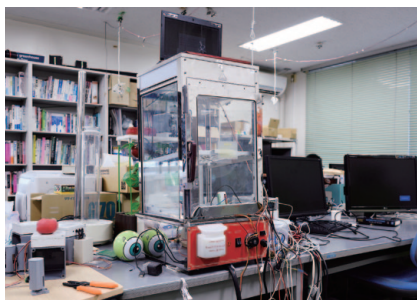
カメラが時々動作しなくなる原因を調べるために、蒸し器の中に入れて動作確認をした
