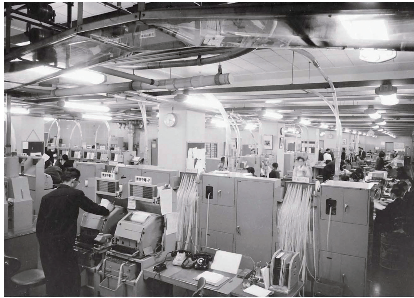
テレプリンタ通信の合理的な運用を目指して開発された 真空管 穿孔テープ気送管。電報通信室の近代設備として注目された
