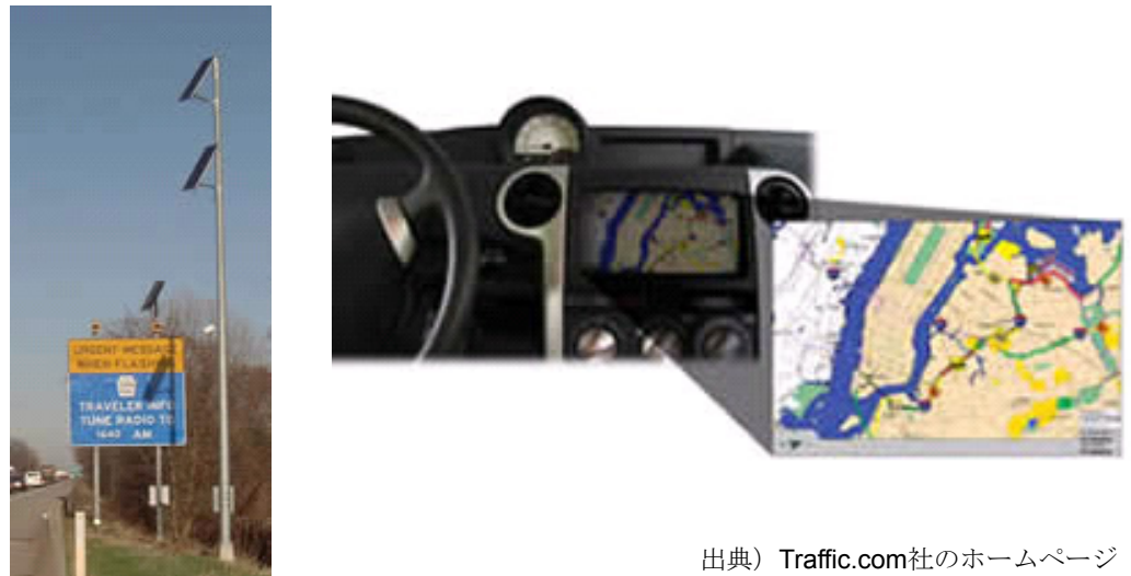
【図表1】 Traffic.com社の路側センサーとカーナビへの渋滞情報配信
