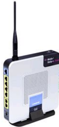
【図表4】専用ルーター「T-Mobile @Home Hiport Wireless router」
