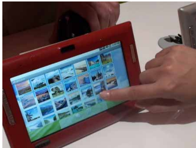
【写真6】 Marvelのチップが搭載されているタブレット端末
