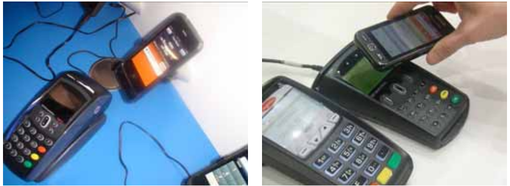
Visa(左)とObethur(右)の、スマートフォンNFCによる課金・認証サービス(筆者撮影)
