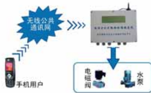
【図表7】 携帯によるリモート灌漑制御システムのイメージ
