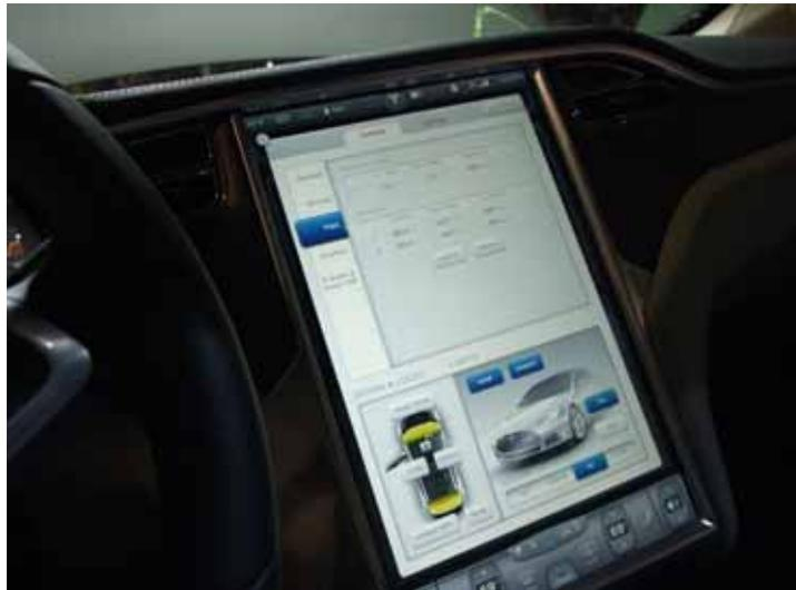
Model Sのフロント・グリルは、ほとんどタブレット・コンピュータのようだ【写真10】。そのサイズは17インチ。画面の上下にある横長のメニューは固定されているが、それらの間にある部分はちょうどアイパッドのように自由に使えるので、ここに様々なアプリを載せることができる。たとえば車の電力使用量を表すグラフ【写真11】や、車体前方に装備されたビデオ・カメラから撮影された映像【写真12】などを表示できる。
