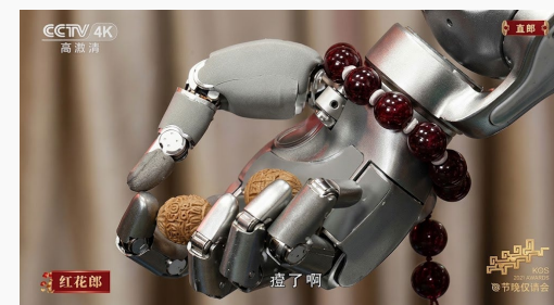
手のひらでクルミを器用に回すデモ。物体の接触状態が動的に変化する難易度の高いベンチマーク
